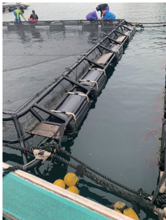
図7 生分解プラスチック製発泡フロートの実用試験 (黒色の浮体が生分解プラスチック製発泡フロートとカバー)
