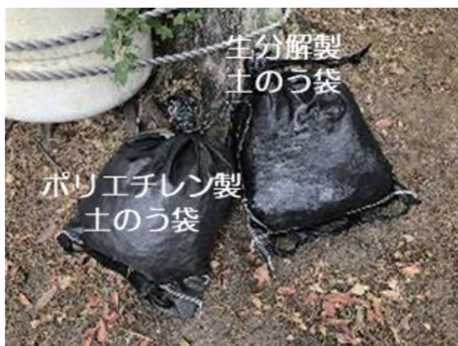
図8 生分解プラスチック製土のう袋(右側が生分解プラスチック製土のう袋)
