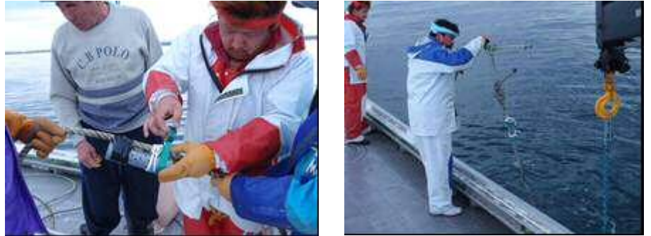
図 10 水温計の取り付け（左）と漁場への設置（右）
